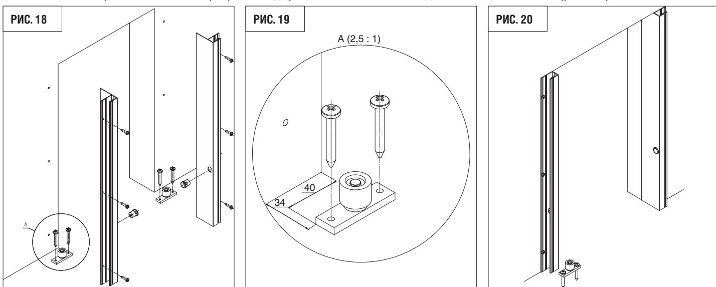
\* При регулировании створок в горизонтальной плоскости ролик направляющей в пол должен оказаться по центру низа створки двери. При монтаже одностворчатой двери установите вертикально профиль-ловитель сразу за профилем под фотоэлементы для фиксации створки в закрытом положении.
