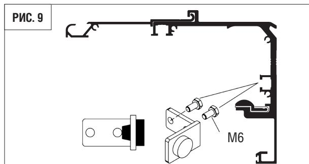
2. Отрегулируйте стопоры таким образом, чтобы в момент касания стопора и каретки подвижная створка в открытом положении выходила из проема не менее чем на 7 мм (рис. 10 Б).
