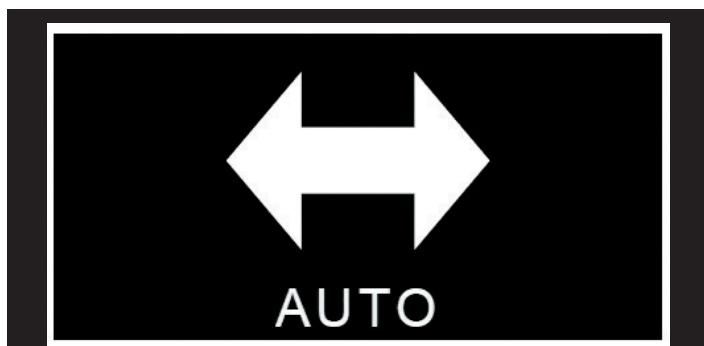
Двери работают в автоматическом режиме на вход и на выход (активация от любых управляющих устройств).
