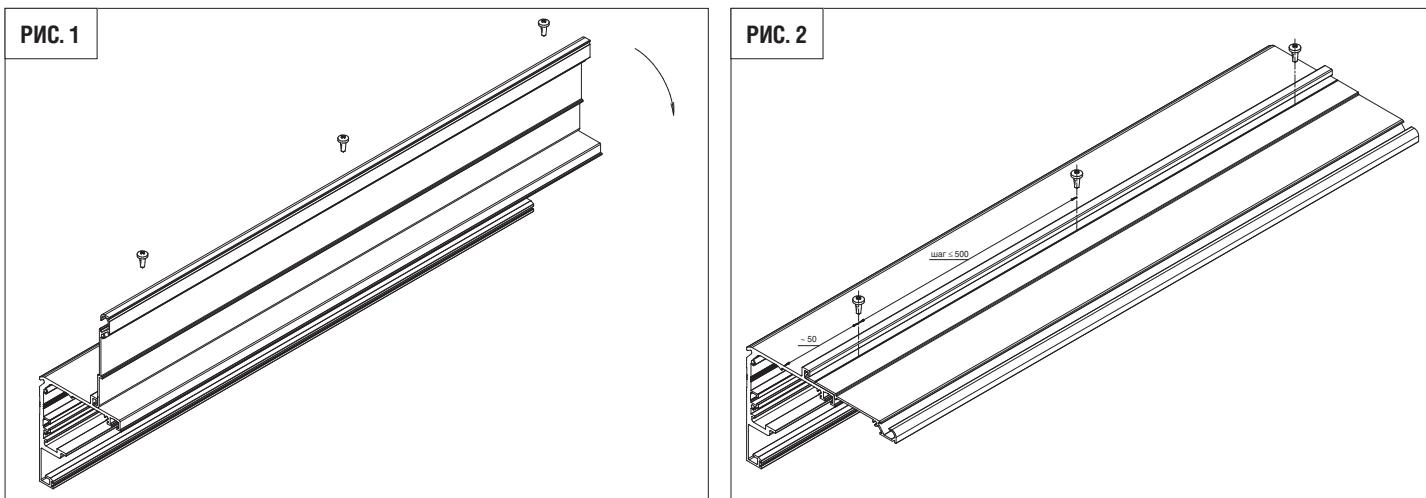
2. Закрепите собранный несущий профиль на высоте проема Н шурупами 5,5 × 45 (60 мм) с шагом 300–400 мм в зависимости от веса створок. Зафиксируйте уплотнитель рельса на рельсе и вставьте рельс в несущий профиль. Протяните фетровый уплотнитель в нижнем пазу несущего профиля (рис. 3).
